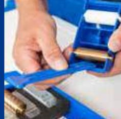
Die Strukturwalzen vorsichtig aus dem Gerät lösen. (Bitte nicht mit einem Schraubenzieher oder ähnlichem Werkzeug die Walzen beschädigen). In eine Führung die weiße Führungsrolle und in die zweite die gewünschte Strukturwalze einsetzen.
