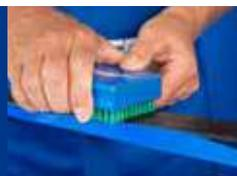
Im Anschluss zügig den noch feuchten Ski mit einer sauberen BaseBrush Steel MicroFinish in Laufrichtung ausbürsten.
