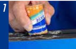
**1** Grip Base in einer dünnen Schicht auftragen.
