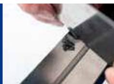
Überschüssiges Material der Repair-Strips mit der Nirostaklinge entfernen.
