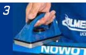
**3** Um die Gleiteigenschaften zu verbessern kann das Fell mit einem Bügeleisen in Laufrichtung bei 80°-100° C behandelt werden.
