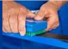
Um die Mikrostruktur des Skis freizulegen, Belag nochmals mit der BaseBrush Steel MicroFinish in Laufrichtung 2-3 mal ausbürsten.
