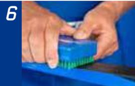
6 Um die Mikrostruktur des Skis freizulegen, Belag nochmals mit der BaseBrush Steel MicroFinish in Laufrichtung 2–3 mal ausbürsten. Dies erzeugt erhebliche Zeitvorteile beim Laufen!
